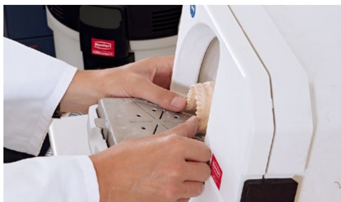
Недорогое универсальное устройство для пескоструйных аппаратов, сухих триммеров, фрезеров для зубных рядов и т.д.
