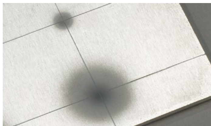
Точная и экономичная струйная обработка. Вверху: Фокусировка луча у Renfert. Внизу: Фокусировка луча у конкурента
